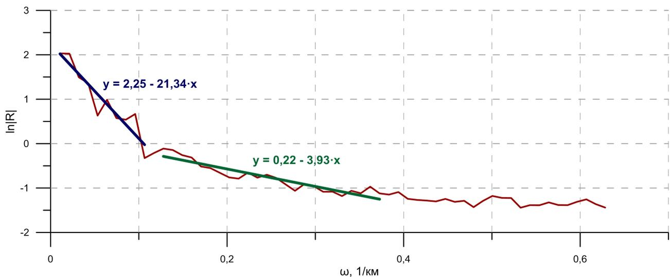
Рис. 1.1. График амплитудного спектра аномального гравитационного поля.
