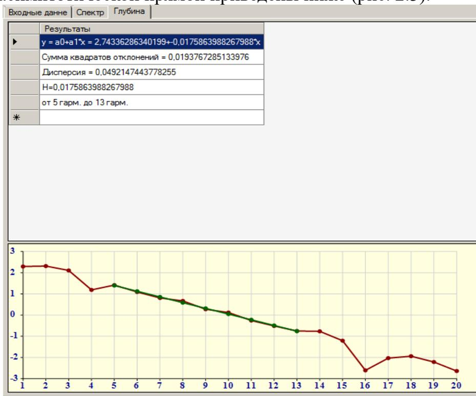
Рис. 2.3. Результаты расчета глубины верхней кромки по номерам гармоник.
